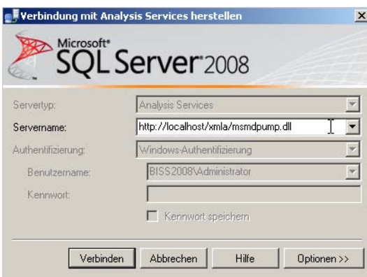
Abbildung 30.17 Im Management Studio eine Verbindung über IIS herstellen
